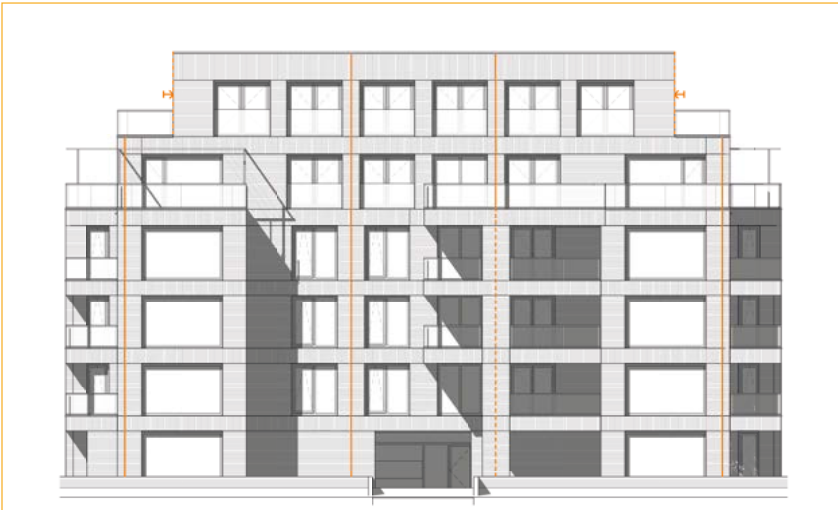
Geen horizontale en veel minder verticale dilatatievoegen in de Brick-BENG
